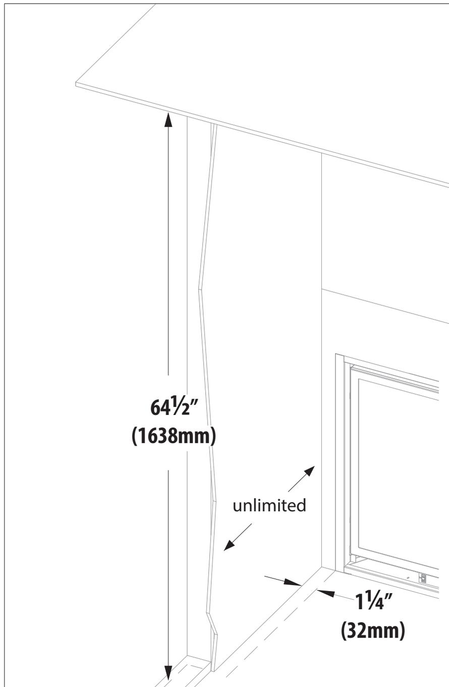
FIGURE 4.3 *Sidewall Clearance*
