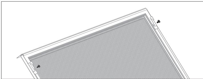
POSITION THE HEAT DEFLECTOR BY SLIDING IT UNDER THE MOUNTING TABS AS SHOWN
