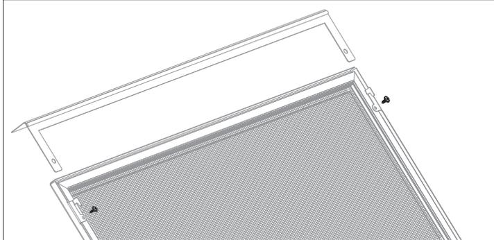
REMOVE (2) SCREWS AS SHOWN LOCATED AT THE BACK OF THE SCREEN FRONT AND ALIGN THE HEAT DEFLECTOR
